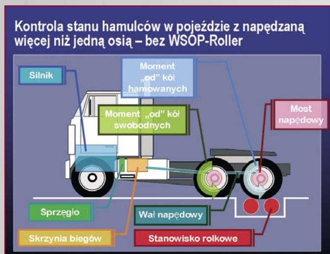
Rys. 1 - kontrola stanu hamulców w pojeździe z napędzaną więcej niż jedną osią - bez WSOP-Roller
