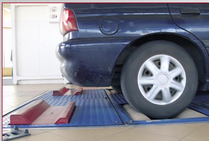
Fot. 5 - badanie sił hamowania na stanowisku rolkowym MAHA
