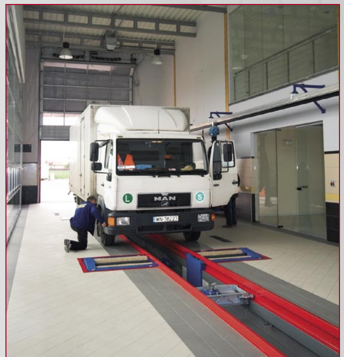
Fot. 1 - kontrola ciśnienia w ogumieniu przed wykonaniem badania
