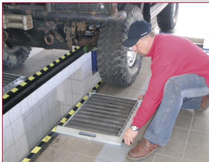
Fot. 7 - WSOP-Roller podpira koła osi niebadanej i pozwala na ich swobodne obracanie się
